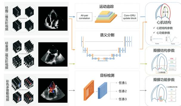
通过运动追踪、语义分割和目标检测等AI算法,提取医学影像特征,实现心腔结构、瓣膜结构及功能参数的自动化测量。
